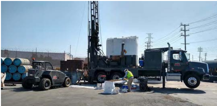
Foto 4: La imagen muestra el equipo de perforación y las muestras de suelo extraídas por el taladro sobre la mesa.
