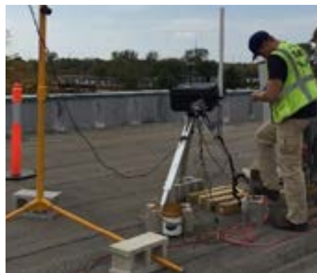
Contratistas de la EPA que comprueban el equipo de muestreo de aire.
