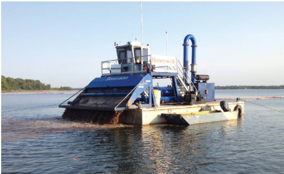
Barcaza regando carbón activado sobre los sedimentos del lago.
