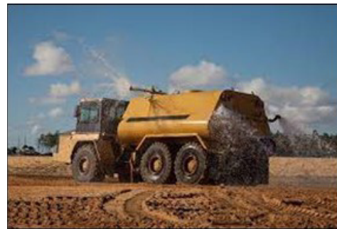
1: Ejemplo de un camión cisterna humedeciendo el suelo para prevenir la generación de polvo en suspensión.
