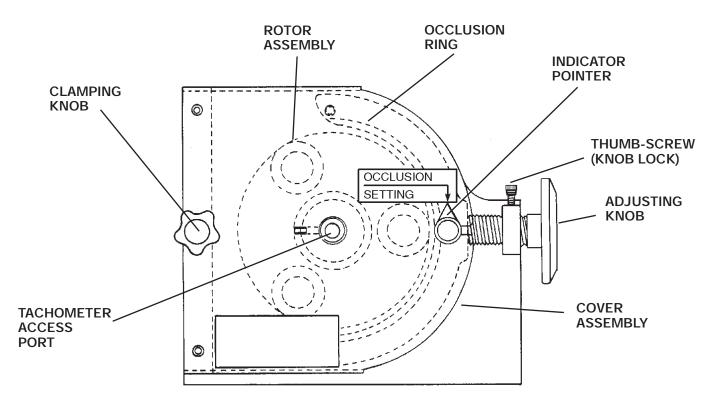
Figure 2. RAPID-LOAD PUMP ASSEMBLY
