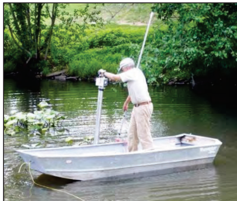
Figure J-5. Mini Vibracore sampling device.
