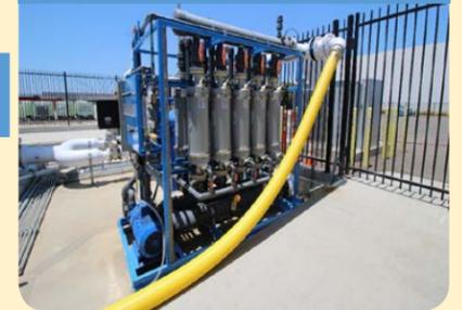
**Ultrafiltración:** Minerales/sólidos no-peligrosos se remueven antes de reinyección
